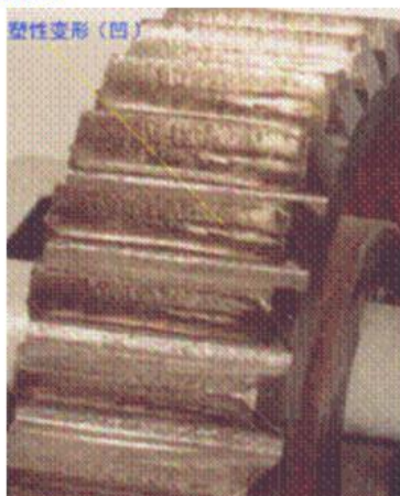
齿轮齿面塑性变形
