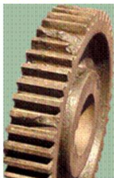
齿轮轮齿断裂
