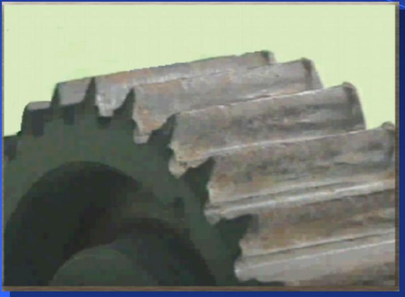
措施：减小模数、降低齿高，变位，提高齿面硬度、降低齿面粗糙度、用抗胶合油和齿轮材料
