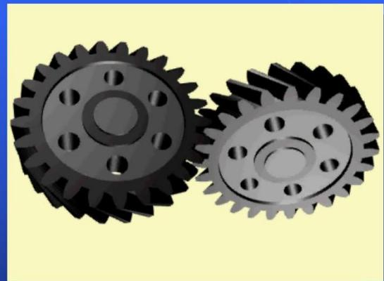
**选择方法：**首先选择第ii公差组，动力传动中，根据传动用途、平稳性要求、节圆圆周速度、载荷、运动精度要求确定
